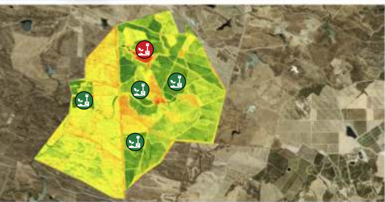
imagen satélite, control de riego sistema DENORI, proporciona ubicación de sensores e incidentes detectados.
